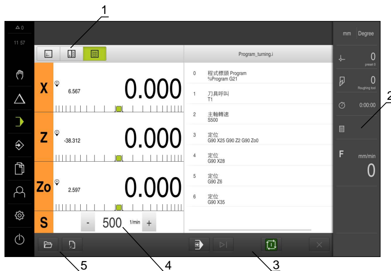
圖形 11: 車削應用模式內的程式執行功能表
