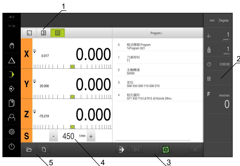
圖形 10: 銑削應用模式內的 程式執行 功能表
