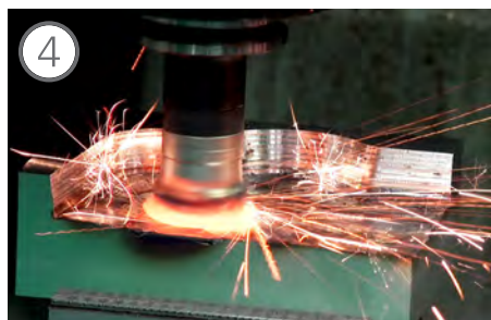
未用AFC功能继续加工72分钟：机床继续工作直到刀具和工件炽热
