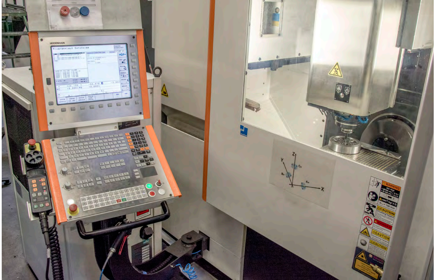
强强联合： 配TNC数控系统的GF加工方案的HEM 500 U加工中心
