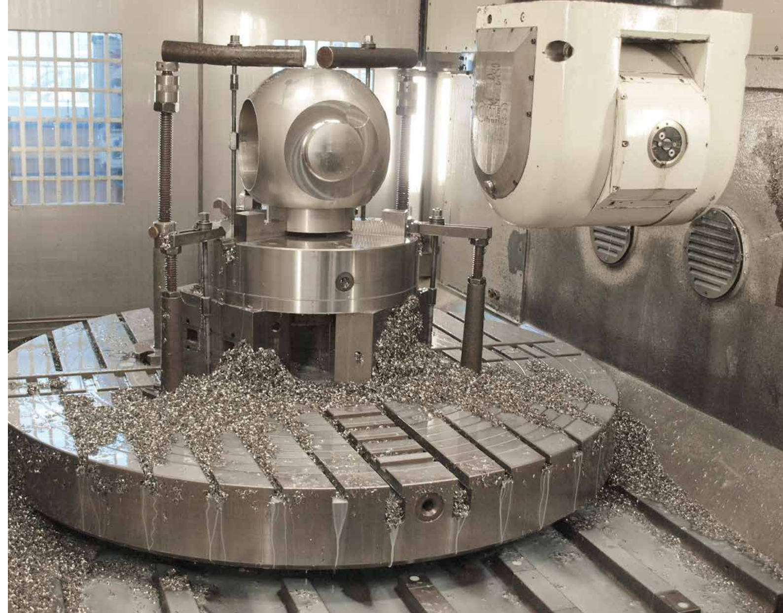
Výroba velkých kulových ventilů z Inconelu 625 je specialitou firmy NAVI.
