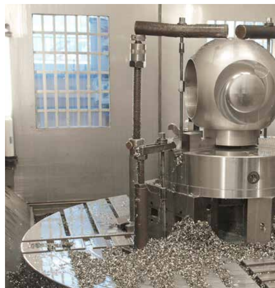
Firma NAVI CZ z Otrkovic: Výroba velkých kulových ventilů z Inconelu 625
