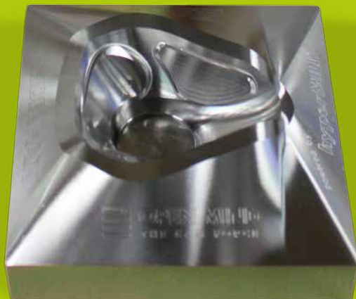
Im Workshop wurde die Form für eine Beatmungsmaske mit der iTNC 530 HSC1 gefräst. Herausforderung war das Material: ein korrosionsbeständiger Kunststoffformstahl 1.2083.
