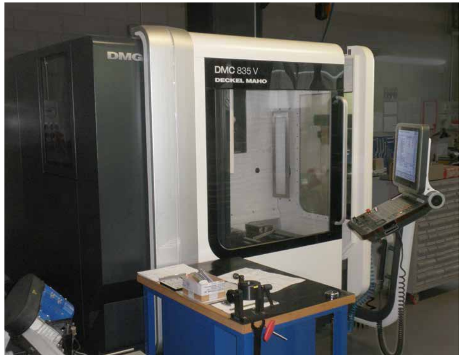
Direkt an den TNC-Steuerungen entstehen NC-Programme, mit denen flexibel und schnell präzise Bauteile gefertigt werden – mit Hilfe von Dreh-, Bohr- und Fräszyklen.
