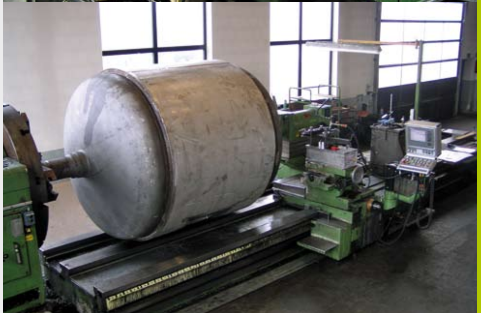
Torneado al vuelo (arriba) Mecanizado de un tambor de hormigonera de 2,1 m de diámetro (abajo)
