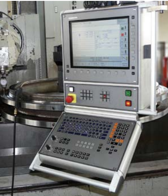
Mecanizado de un eje de generador de 8 toneladas de peso en la fresadora lateral Zayer controlada por el iTNC 530
