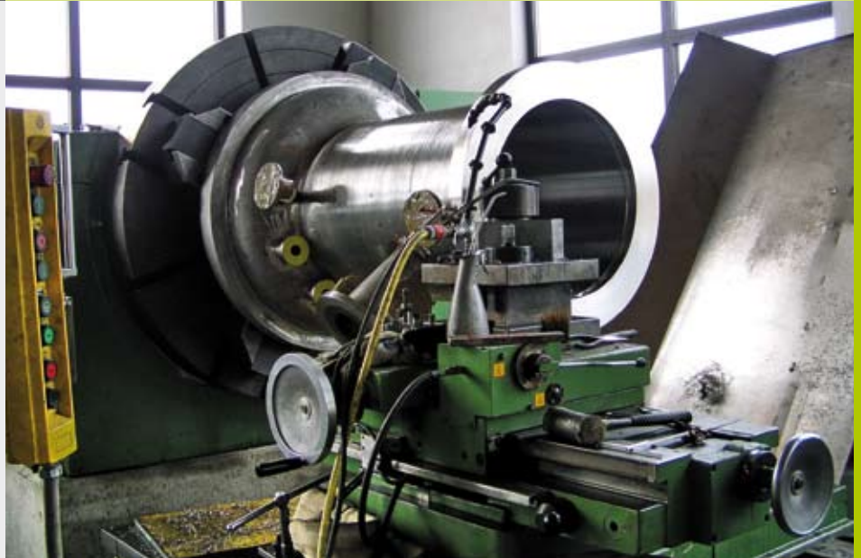
Mecanizado de un eje de generador de 8 toneladas de peso en la fresadora lateral Zayer controlada por el iTNC 530
