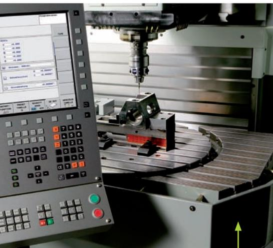
*TNC 620: la gamma di prodotti HEIDENHAIN si arricchisce di un nuovo controllo numerico compatto con regolazione digitale degli azionamenti.*
